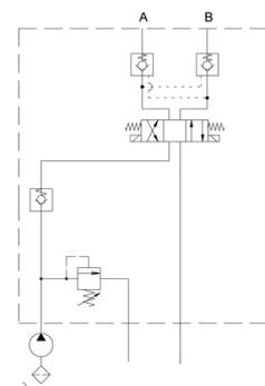
Die Ausführung für reversible Pumpen sieht hingegen einen vorderen Steuerblock mit doppeltem Überdruckventil und doppelter Öldruckleitung zum hinteren Hydrauliksteuerblock vor. Die saugseitigen Rückschlagventile befinden sich an der hinteren Abdeckung der Zahnradpumpe, während sich das optionale hydraulisch entsperrende Doppelrückschlagventil am hinteren Hydrauliksteuerblock befindet.
