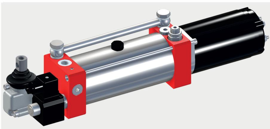
Dem Konzept liegt ein ganz normales Mini-Hydroaggregat zugrunde, das aus einer von einem Gleichstrom-Elektromotor angetriebenen Außenzahnradpumpe besteht. Der von der Pumpe bereitgestellte Ölvolumenstrom hängt von ihrem Fördervolumen und von der Drehzahl des angeschlossenen Elektromotors, bei entsprechendem Betriebsdruck ab. Die Zahnradpumpe kann unidirektional oder reversibel ausgeführt sein.
