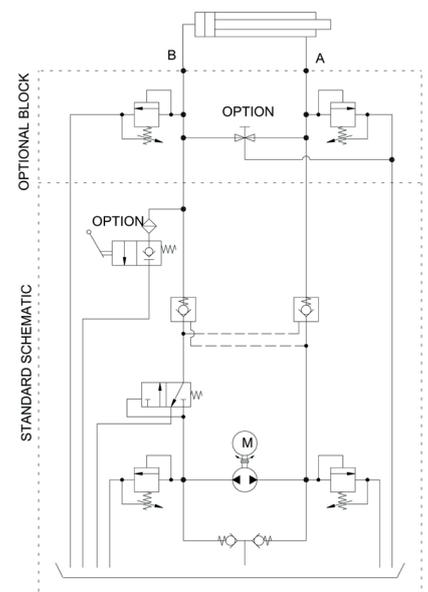
Aufgrund seiner Auslegung eignet sich dieses Mini-Aggregat auch optimal für die direkte Kombination von Aggregat + Zylinder. Damit können Einbaumaße in Maschinen erheblich optimiert werden, da Hydraulikleitungen entfallen. Ferner ist zu beachten, dass das Aggregat UP40 sowohl in horizontaler als auch in vertikaler Einbaulage arbeiten kann.
