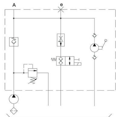
Eine Ausführung mit 4-Wege-Schieberventil mit 2 oder 3 Schaltpositionen für die Steuerung von doppelwirkenden Zylindern ist bereits vorgesehen. Diese wird auch die Möglichkeit zur Montage eines hydraulisch entsperren Doppelrückschlagventils beinhalten, um den Effekt der für Schieberventile typischen Undichtigkeiten auf ein Minimum zu reduzieren.
