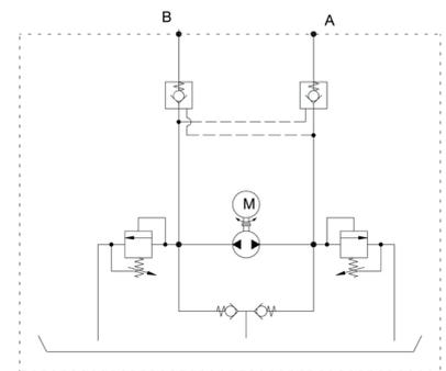
Die Außenzahnradpumpen in unidirektionaler als auch reversibler Ausführung gehören für diesen Aggregattyp zur Baureihe 05 mit Fördervolumina von 0,25 ccm/rev bis 0,9 ccm/rev. Höhere Fördervolumina sind zwar verfügbar, passen jedoch nicht zur Leistung der eingesetzten Elektromotoren.
